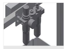
Wartungseinheit Wartungseinheit für Druckluftwerkzeuge
