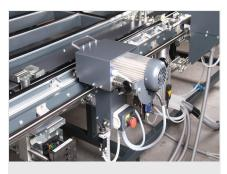
Pneumatische Höhenverstellung für Schlosskasten
