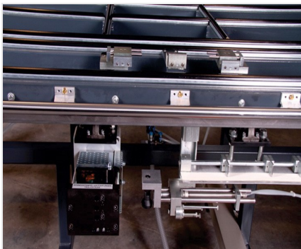
Beschlagstanze Beschlagstanze mit Anschlägen für Griffsitz mittig und konstant. Beschlagstanze mit offenem Schnittwerkzeug
