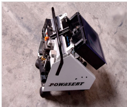
Schraubenzuführgerät Vorschubschrauber mit automatischer Schraubenzuführung
