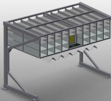
Beschlagregal mit 36 Fächern für übersichtliche Lagerung der Beschläge am Flügelmontageplatz
