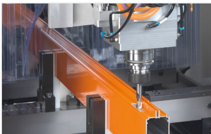
SBZ 140 Centrum pro obrábění tyčí
